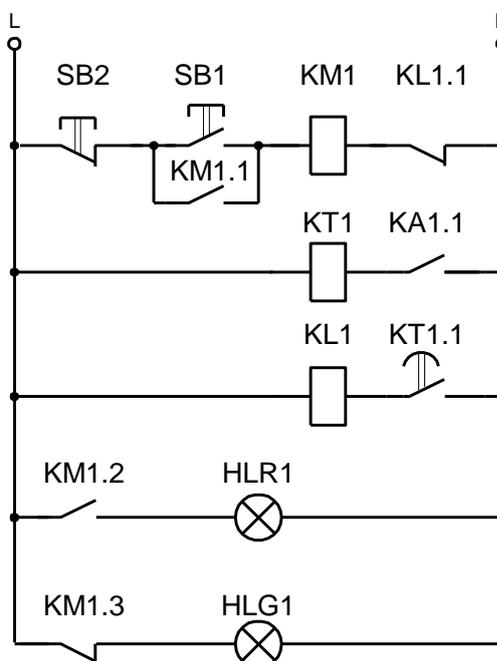
При подаче напряжения на схему загорается зеленая сигнальная лампа HLG1.
