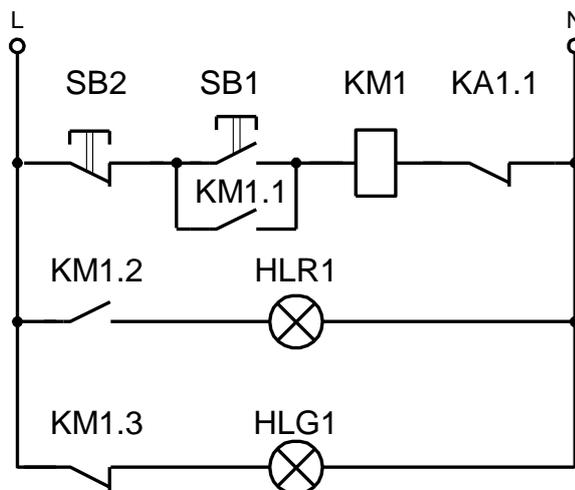
При подаче напряжения на схему загорается зеленая сигнальная лампа HLG1.
