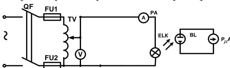
Рис.5.1 Электрическая схема для исследования источника ИК излучения
