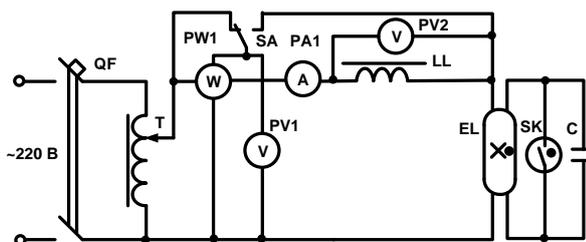
Рис.2.2. Принципиальная электрическая стартерная схема включения люминесцентной лампы
